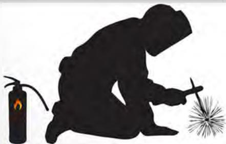
• Přechodná svářečská pracoviště jsou vybavena vhodnými hasicími přístroji a jinými hasebními prostředky podle zvláštních právních předpisů. Mimo tyto hasicí přístroje se vybaví ještě nejméně dvěma přenosnými hasicími přístroji s vhodnou náplní, z toho jedním přenosným hasicím přístrojem práškovým o hmotnosti hasební látky nejméně 5 kg.
